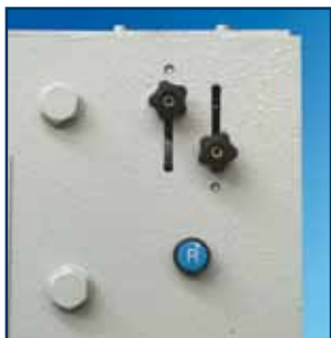
Regolazione della corsa (Cesoia).
