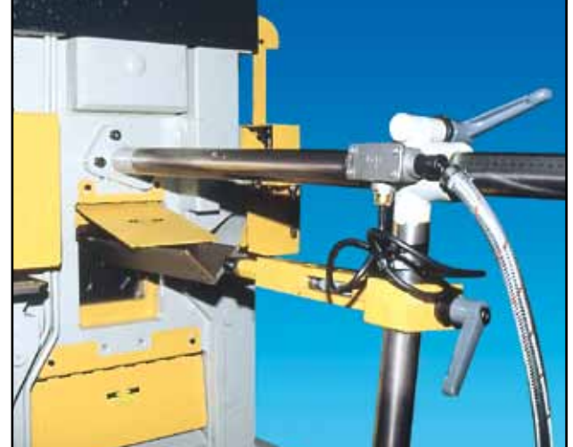
▲ Calibro elettromeccanico di misura m. 1-2-3.
