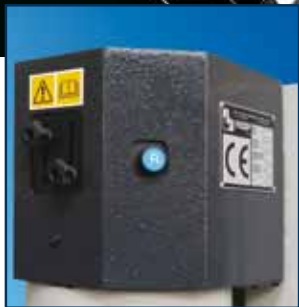
Regolazione della corsa (Punzonatrice).
