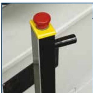
Pedale di comando con pulsante di emergenza.
