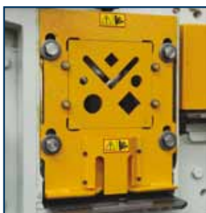
Trattenitore regolabile in altezza per cesoia piatti e tagliaferri.
